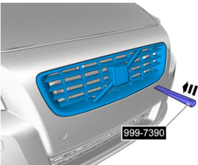
Se till att inte skada lackerade ytor. Använd 999-7390
