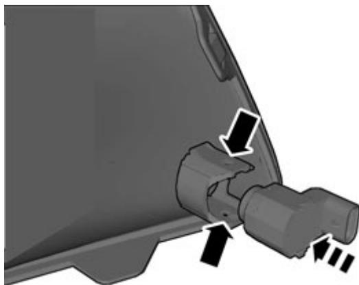
Instale o sensor no novo painel. Assegure-se de que todos os ganchos de fixação ficam presos.
