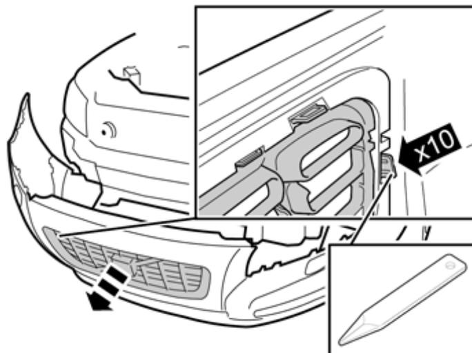
Pegue numa ferramenta para fita de calafetar e force cuidadosamente em torno dos orifícios dos fixadores da grelha, de modo pressioná-los para fora e soltar a grelha. Coloque-a de lado, há uma grelha nova no kit.
