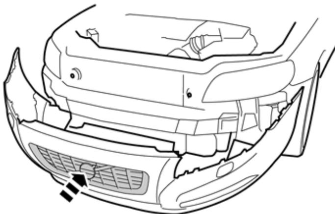
Retire nova grelha do kit e fixe-a. Assegure-se de que todos ganchos de fixação ficam presos.
