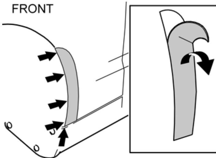
Retire a protecção da fita de protecção
