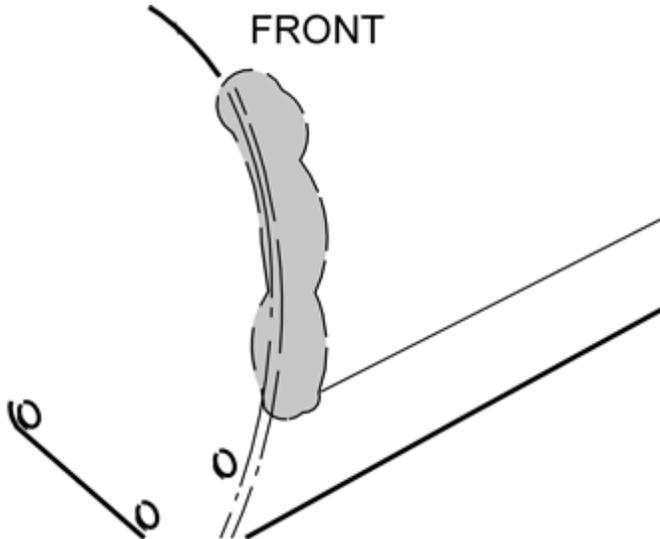
Limpe a superfície marcada na extremidade traseira da aba dianteira. Utilize uma mistura de 30% de fluido de lavagem do pára-brisas e 70% de água. Seque com um pano.
