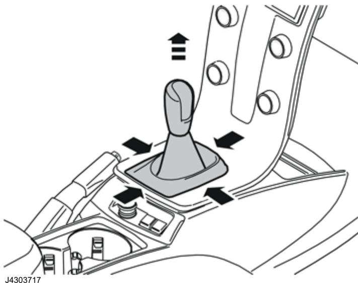
Retire a maçaneta da alavanca do selector de mudanças juntamente com a capa protectora. Solte a capa protectora da consola central libertando os ganchos de fixação que se encontram nos sítios que setas indicam. De seguida puxe toda a unidade para cima.
