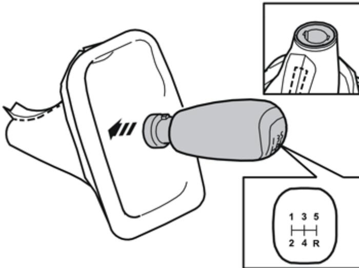
Infilare la manopola della leva selettrice all'interno della cuffia rivoltata. Il testo sulla manopola della leva selettrice deve puntare sul lato opposto della cucitura nella cuffia.
