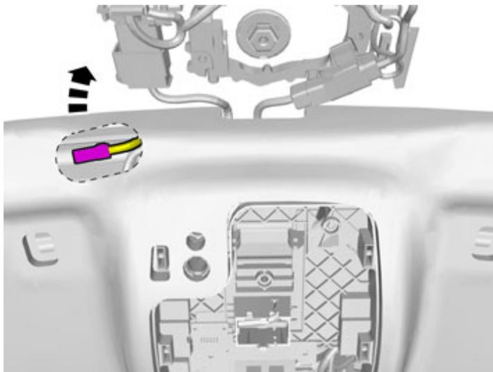
Localizzare il connettore esistente nel cablaggio del veicolo.
