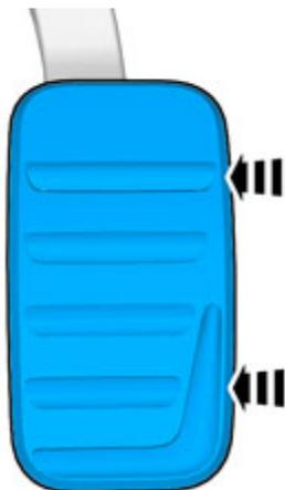
Spingere il gommino del pedale contro il pedale e piegare simultaneamente il profilo del gommino del pedale sopra il pedale aiutandosi con un piegatore.
