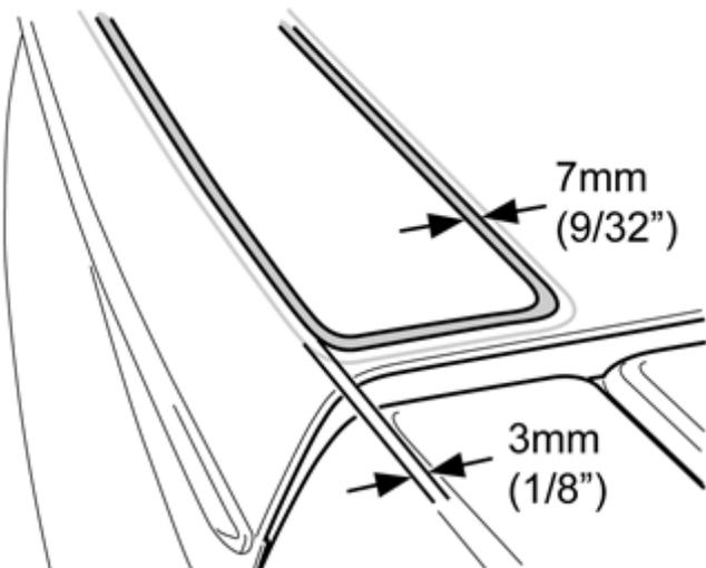
Applicare un cordolo di primer dallo spessore di 7 mm (9/32") attorno al pannello del portello posteriore; 3 mm (1/8") prima delle linee tracciate e della giunzione tra il portello del bagagliaio ed il relativo pannello.
