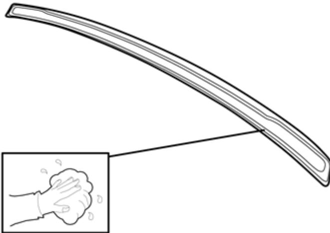
Asciugare il nastro protettivo del nastro di fissaggio dello spoiler prima della marcatura sul portello posteriore.
