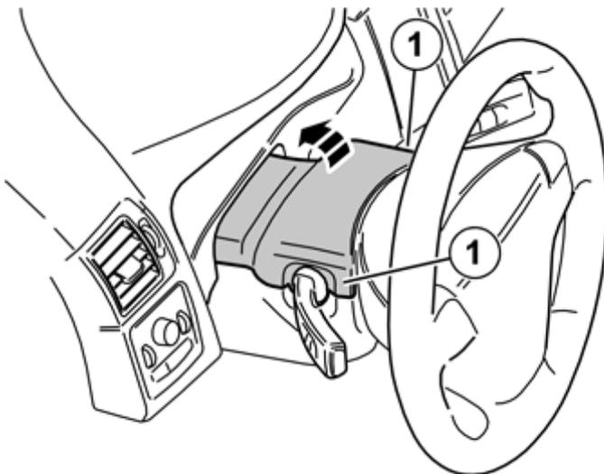
Scalzare con cura la semiscatola del piantone dello sterzo da quella inferiore. Usando un attrezzo per guarnizioni di plastica, scalzare il bordo posteriore nel giunto tra le semiscatole del piantone dello sterzo. Le semiscatole del piantone dello sterzo sono fissate l'una all'altra da fermi (1) sull'interno
