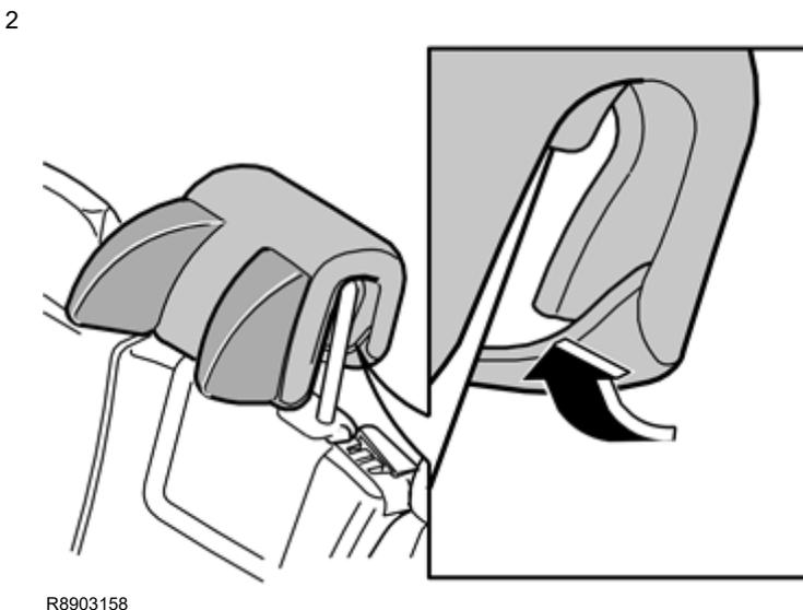
Passer la garniture rembourrée au dos de l'appui-tête et la fixer autour du bord inférieur arrière de l'appui-tête.
