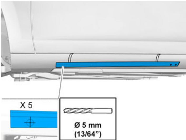
Percer les cinq trous repérés sur le support avec une mèche de  $\text{Ø } 5 \text{ mm}$  ( $13/64''$ ).
