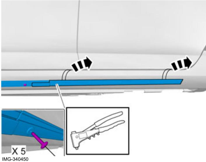
Fixer le support avec un rivet dans chaque trou du panneau du seuil.
