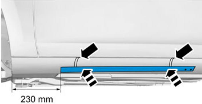
Adapter le bord avant du support d'après la cote mesurée à partir du bord avant du panneau du seuil. Veiller à ce que le ruban adhésif n'adhère pas encore. Accrocher le support au-dessus du panneau du seuil.
