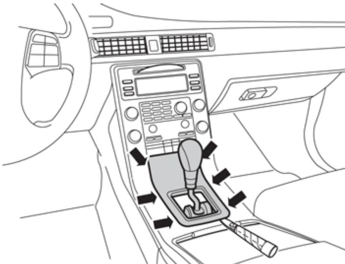
Forcer avec un levier avec précaution le panneau autour du levier de vitesse. Il est fixé avec six crochets de blocage le long des longs côtés. Commencer à forcer au niveau du bord arrière du panneau.
