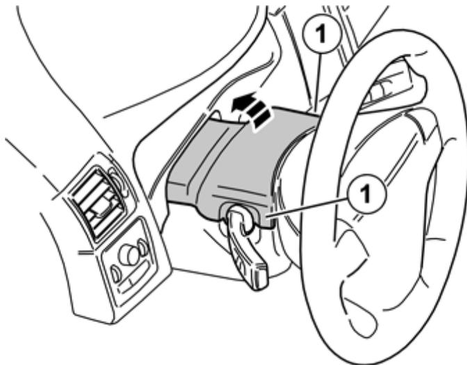
Faites levier avec précaution sur la protection inférieure pour la détacher de la colonne de direction. Utilisez un outil pour joint d'étanchéité en plastique, faites levier au niveau du bord arrière à la jointure entre les protections de la colonne de direction. Les protections de la colonne de direction sont fixées l'une à l'autre à l'aide de loquets (1) à l'intérieur
