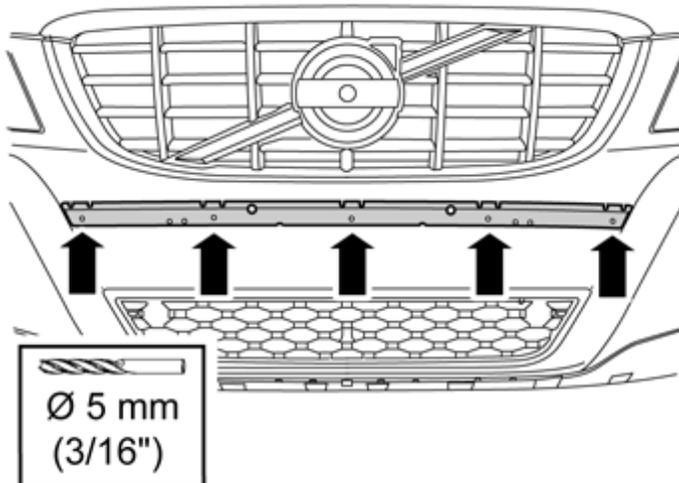
Prenez la mèche de  $\varnothing 5$  mm ( 3/16"). Percez les trous préparés du support ainsi que l'enveloppe du pare-chocs. Percez 10 à 15 mm ( 23/64 - 19/32") de profondeur dans l'enveloppe du pare-chocs pour les rivets pop.
