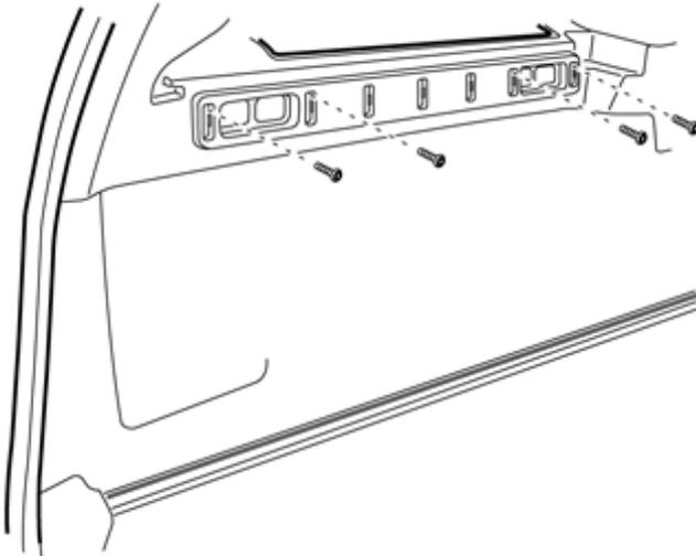
Ajuster le rail, sans que l'adhésif ne colle, de manière à ce que les quatre vis puissent être vissées dans le panneau latéral. Les vis ne sont pas autotaraudeuses et il est possible de ressentir une certaine résistance lors de la pose.
