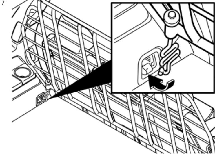
Introduzca desde abajo el soporte de la fijación por la fijación inferior de la rejilla de seguridad del maletero, como en la ilustración. Atornille en el botón
