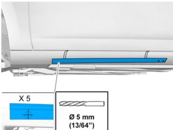
Agrandar los cinco orificios marcados en el soporte con una broca de Ø 5 mm (13/64").
