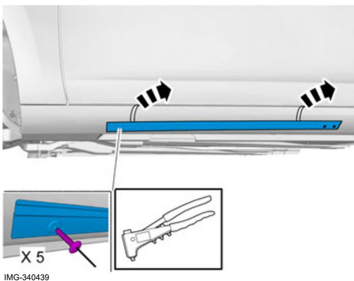
Fijar el soporte con remaches en todos los orificios del umbral.
