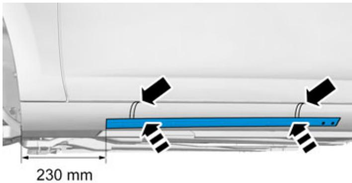
Adaptar el borde delantero del soporte a la cota medida desde el borde delantero del panel de umbral. No fijar la cinta adhesiva todavía. Enganchar el soporte en la parte superior del panel de umbral.
