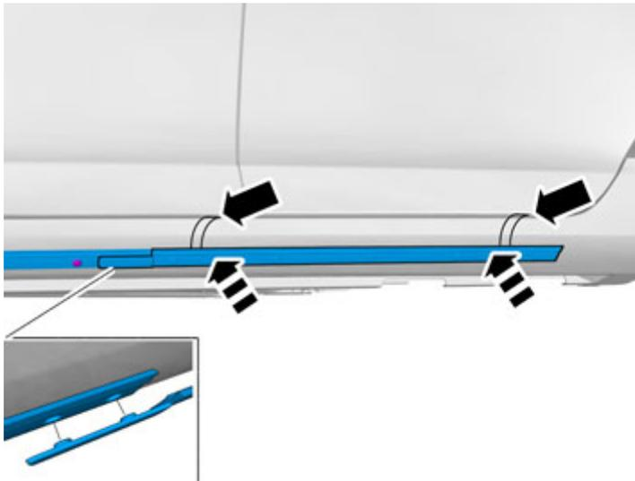
Insertar las espigas del soporte en los orificios correspondientes en el soporte delantero. No fijar la cinta adhesiva todavía.
