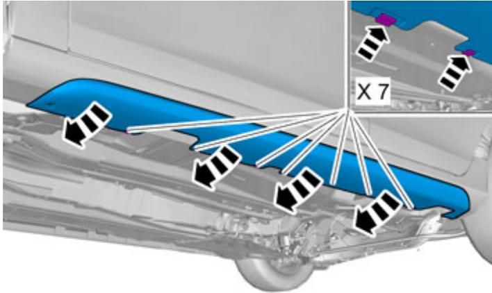
Sacar siete presillas del kit y fijar el borde inferior de la placa en el borde inferior del panel de umbral, en las posiciones previamente marcadas. Empezar con las dos presillas inferiores y continuar hacia los extremos de la placa.
