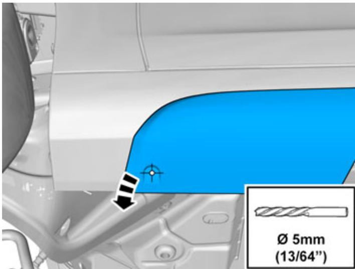
Plegar con fuerza el extremo delantero de la placa alrededor del borde inferior del panel de umbral y agrandar el orificio del panel de umbral con una broca de 5 mm (13/64").
