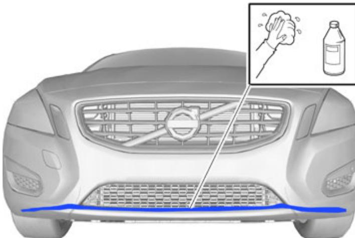
Limpiar con isopropanol los lugares en que se ha pegado cinta adhesiva en la placa protectora de bajos. Secar.
