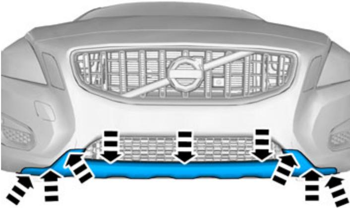
Fijar bien la placa protectora de bajos frente a la cinta de fijación alrededor.
