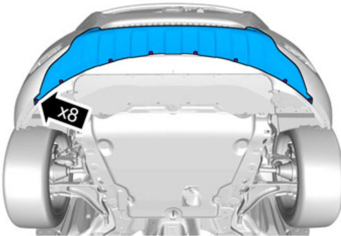
Fijar la parte inferior de la placa protectora de bajos con tornillos del kit. Empezar desde el centro hacia los lados.
