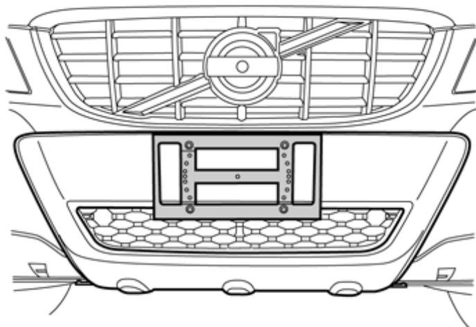
Montar el soporte de la matrícula con tornillos nuevos 4,8 x 14 mm (3/16 x 35/64") del kit, según las marcas.
