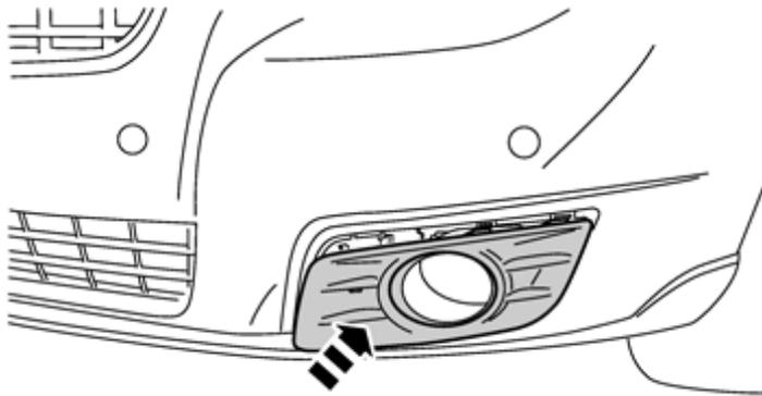
Monte un nuevo panel de recubrimiento procedente del kit alrededor de la luz antiniebla en la funda del parachoques. Asegúrese de que se apliquen todos los ganchos fijadores.
