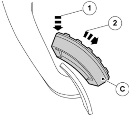
Sacar el revestimiento de pedal de freno (C) del kit.
