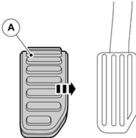
Sacar el revestimiento de pedal acelerador (A) del kit.
