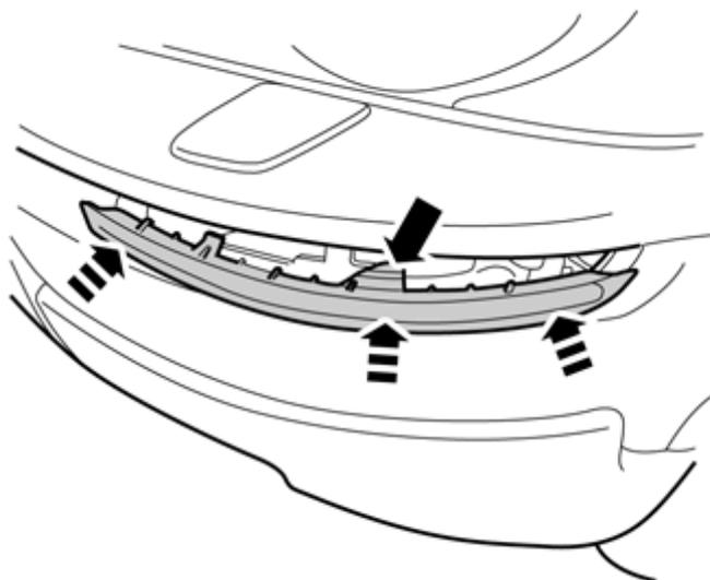
Insertar el panel decorativo en la escotadura y fijarlo a presión. Comprobar que todos los ganchos agarran.
