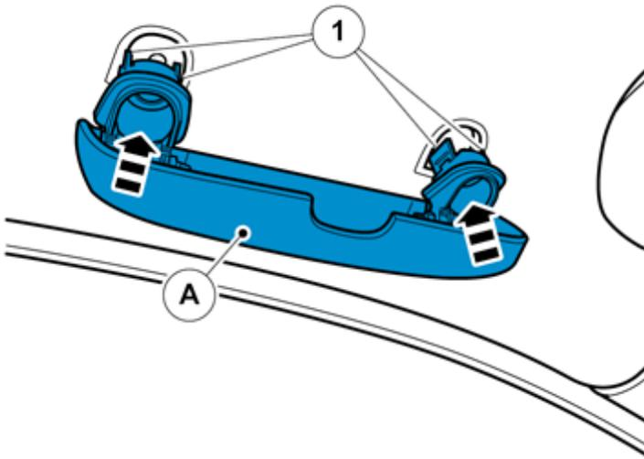
Comprobar que las cuatro chapas de bloqueo (1) quedan cada una a un lado de las placas de tuerca donde va a fijarse el soporte de gafas. Si las chapas no caben, pueden romperse y desecharse.
