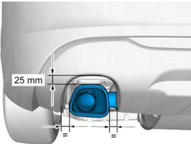
Centrar el tubo final en el rebaje de la placa protectora de bajos como en el dibujo.
