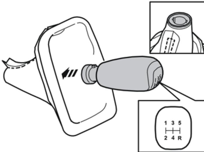
Inserte el pomo de la palanca de cambios en el fuelle vuelto del revés. El texto del pomo de la palanca debe apuntar desde la costura del fuelle.
