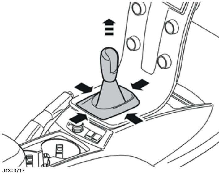
Desmonte el pomo de la palanca de cambios y el fuelle. Para ello, sacar este último haciendo palanca desde la consola central en los ganchos de fijación, donde indican las flechas, y, a continuación, tirando hacia arriba de toda la unidad.
