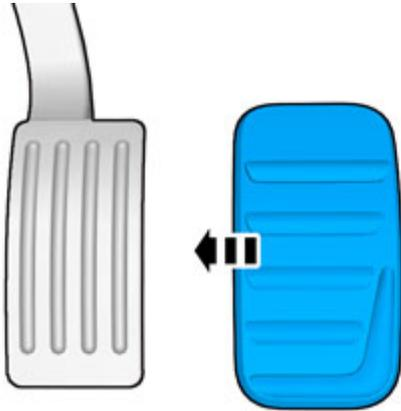
Den Pedalgummi an der Längsseite einhängen.
