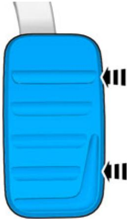
Den Pedalgummi gegen das Pedal drücken und gleichzeitig das Profil des Pedalgummis mit Hilfe eines Falzbeins über das Pedal biegen.
