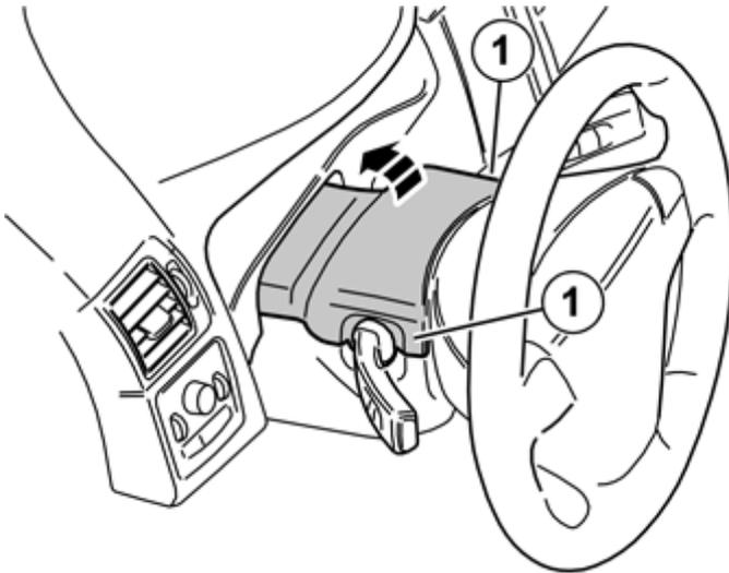
Die obere Lenksäulenverkleidung vorsichtig von der unteren Verkleidung abhebeln. Ein Dichtungswerkzeug aus Kunststoff verwenden, an der Hinterkante in der Verbindung zwischen den Lenksäulenverkleidungen hebeln. Die Lenksäulenverkleidungen sind mit Rasten (1) an der Innenseite aneinander gesichert
