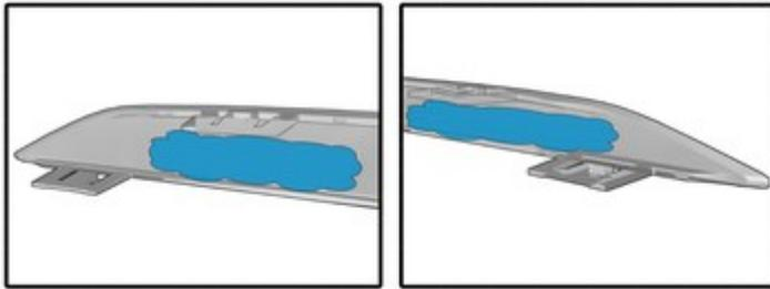
Eine dünne Schicht Grundierung auftragen.
