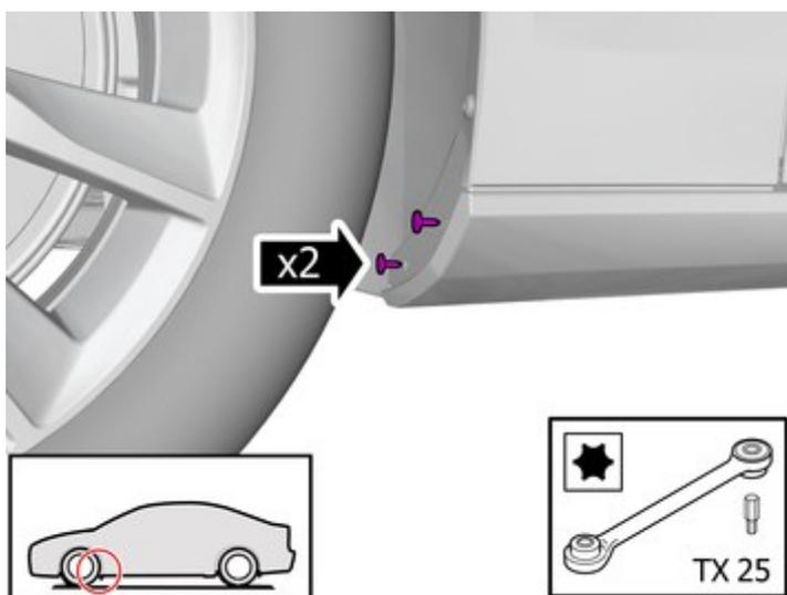
Die Schrauben einsetzen.
