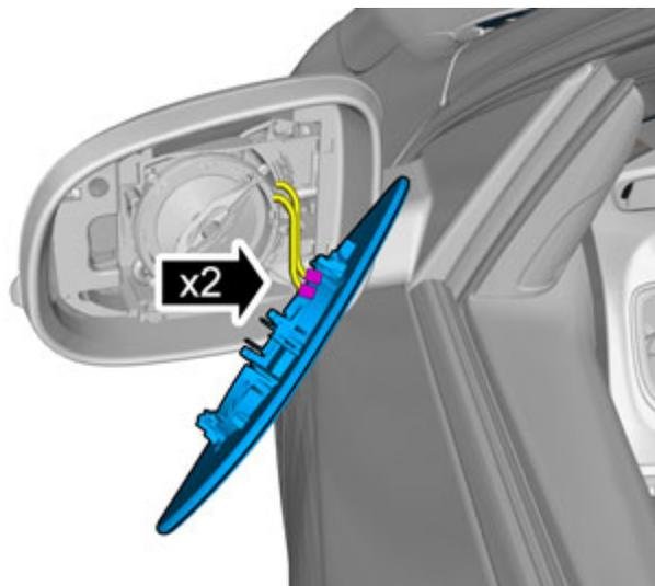
Die Steckverbinder lösen.
