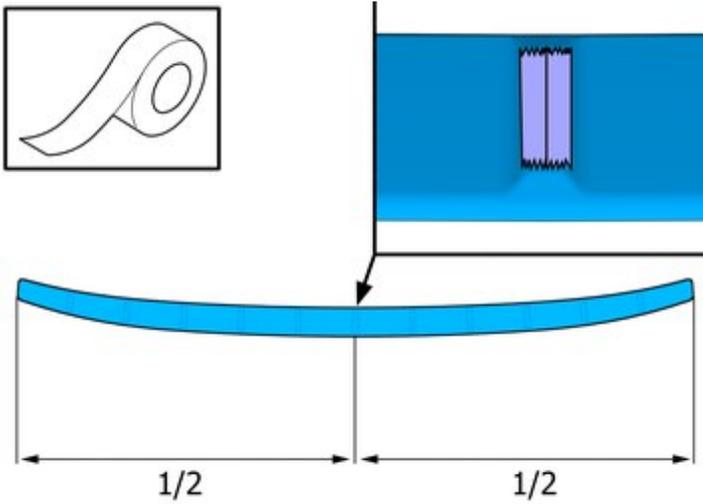
Mit einem geeigneten Klebeband die Mitte kennzeichnen.
