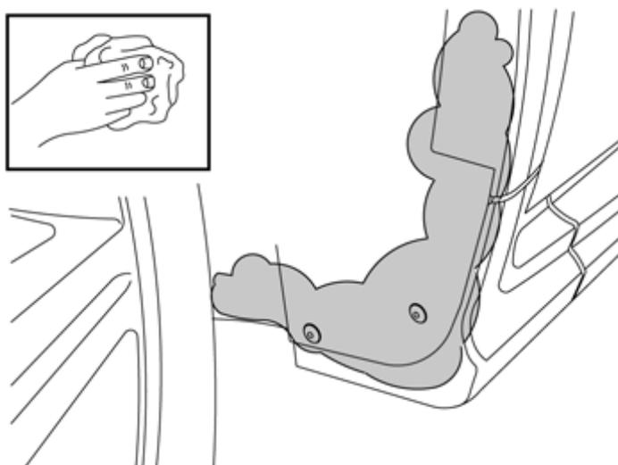
Den Bereich, an dem der Schmutzabweiser anzubringen ist, reinigen.
