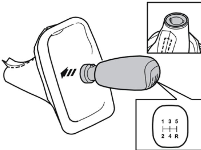
Den Wählhebelknauf in die umgestülpte Wählhebelmanschette einführen. Der Text auf dem Wählhebelknauf muss von der Naht der Manschette weg zeigen.
