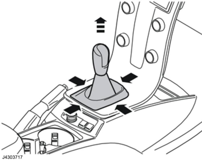
Den Schalthebelknopf mit Manschette entfernen. Dazu die Manschette von der Mittelkonsole abhaken. Die Pfeile zeigen, wo die Befestigungshaken sitzen. Dann die gesamte Einheit nach oben ziehen.
