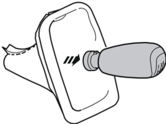
Den Schalthebelknauf von der Manschette abziehen.
