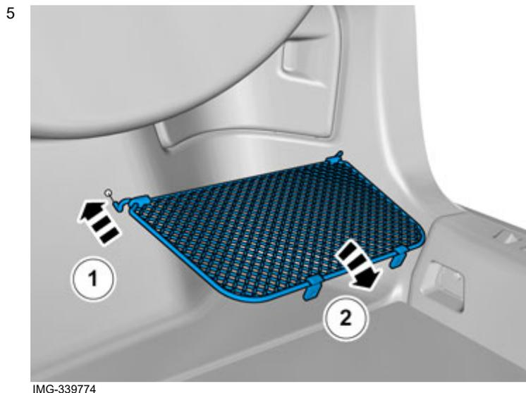
Die vordere Halterung in die Verkleidung einführen und die Netztasche nach unten klappen.
