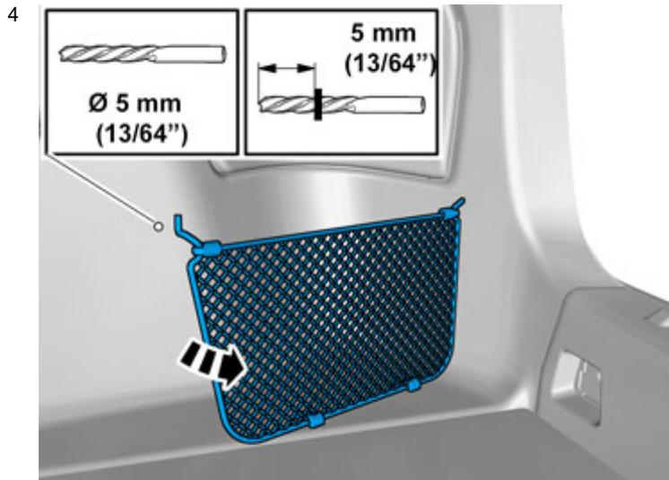
Die vordere Halterung zur Seite schieben und das Loch bohren.
