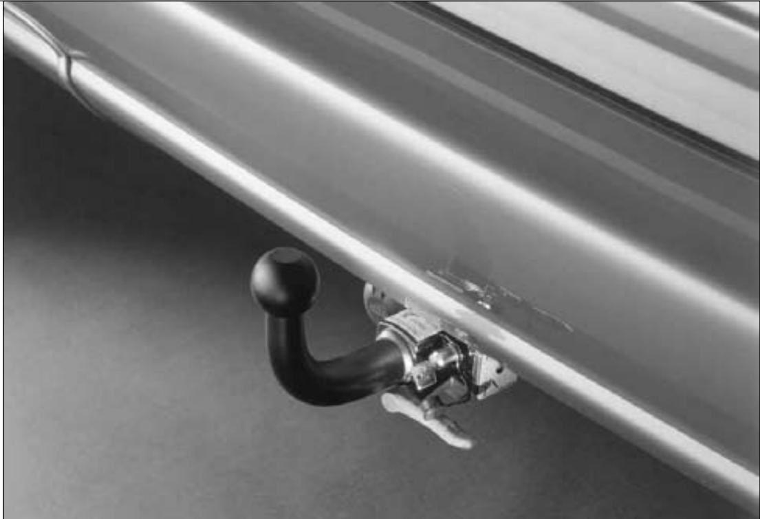
**Bola de remolque, desmontable**
