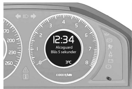
Un messaggio appare sul display quando il test non è approvato. Attenersi alle istruzioni del messaggio e ripetere il test di espirazione quando la spia indicatrice "Soffia" si riaccende in colore verde.
