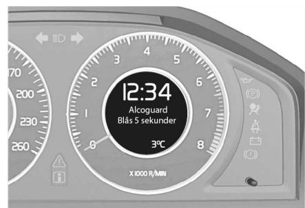
Aparece uma mensagem de erro no mostrador se o teste não obtiver aprovação. Siga as instruções da mensagem e repita o teste de expiração quando a luz indicadora de "Soprar" se acender novamente com luz verde.
