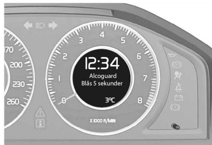
サンプルが承認されなかつた場合、メッセージがディスプレイに表示されます。"Blow (呼気)" ステータスランプが再び緑に点灯したら、メッセージの指示に従つて、もう一度呼気サンプルを吹き込んでください。
