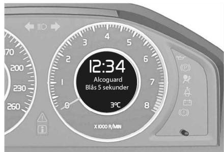
Ett meddelande visas i displayen om provet inte godkänts. Följ instruktionen i meddelandet och gör om utandningsprovet när "Blås"-indikeringssignalen åter lyser grönt.
