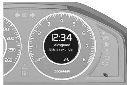
Eine Meldung erscheint im Display, wenn die Überprüfung nicht bestanden wird. Den Anweisungen in der Meldung folgen und die Überprüfung der Atemluft durchführen, wenn die "Ausatmen"-Kontrolllampe wieder grün leuchtet.
