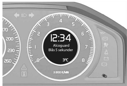
Als de test niet is goedgekeurd, verschijnt er een melding op het display. Volg de instructie in de melding en voer de blaastest nogmaals uit als het controlelampje "Blazen" weer groen is.
