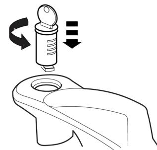
— Coloque a chave na fechadura, baixe a fechadura na sede e rode.
