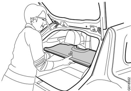
Les systèmes de verrouillage sont placés sur la face inférieure du cache-bagages.
