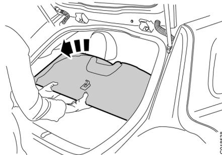
– Relever le cache-bagages par le bord arrière et l'incliner vers le bas et vers l'arrière.
