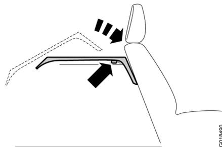
－ サポートラグに入るように、サポートラグの上へカーゴカバーの前端を下ろします。
