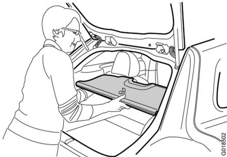
Låsen är placerade på insynsskyddets undersida.
