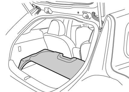
– Abaisser le cache-bagages sur le plancher du compartiment à bagages.
