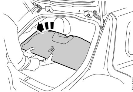
– Die Sichtblende an der Hinterkante anheben und nach unten und hinten winkeln.
