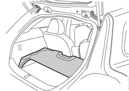
– Coloque la cubierta sobre el suelo del maletero.
