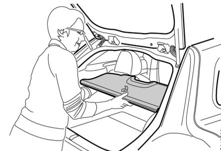
－ カーゴカバーを水平に保ちながら、リアキャッチを外します。キャッチがはまったことを確認します。
