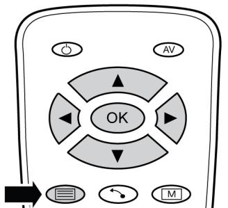
Utiliser les touches de navigation pour sélectionner et modifier les réglages dans les sous-menus. Appuyer sur OK pour sauvegarder le réglage.
