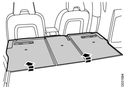
– リアバックレストを倒します。
