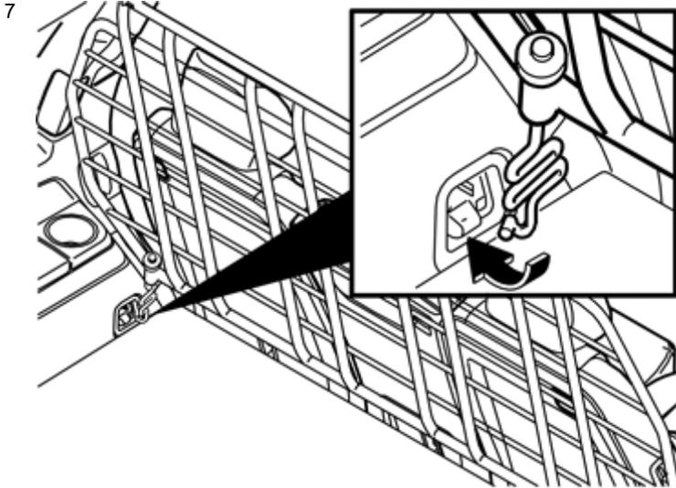
Insérez le support de fixation par le dessous à travers le support inférieur dans la grille de sécurité du compartiment à bagages comme le montre l'illustration. Vissez la molette
