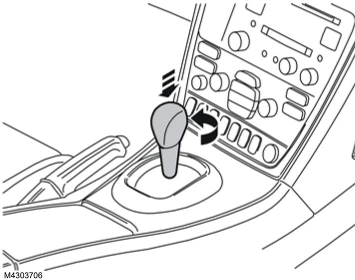
Empuje el pomo de la palanca del cambio de marchas hacia abajo y gire una  $\frac{1}{4}$  vuelta hacia la izquierda.
