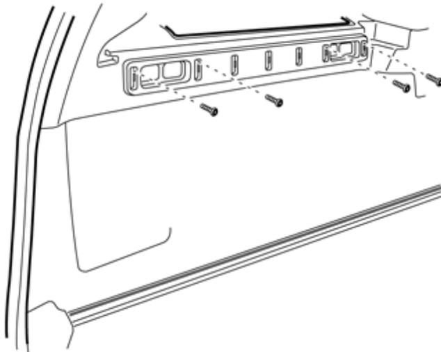
Die Schiene so einpassen, dass die vier Schrauben in die Seitenverkleidung geschraubt werden können, jedoch ohne dass das Klebeband haftet. Die Schrauben sind selbstschneidend. Beim Einschrauben kann ein bestimmter Widerstand auftreten.
