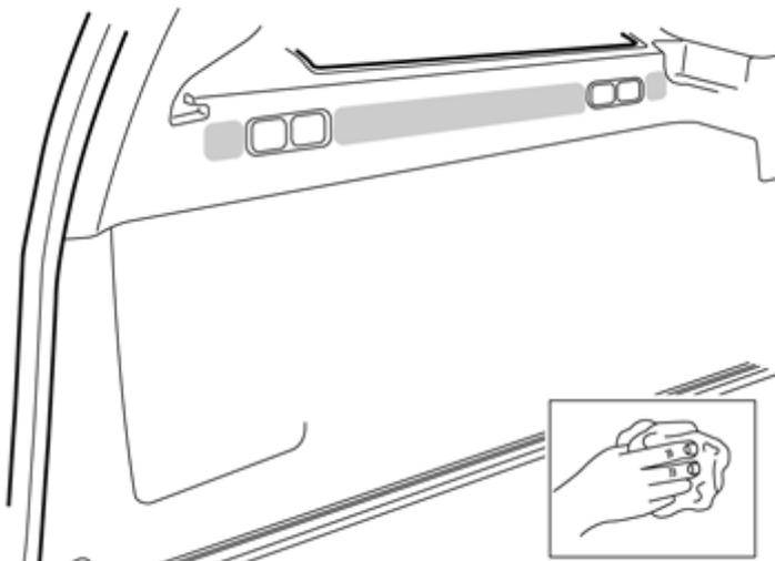
Die gekennzeichneten Flächen mit einem milden, nicht ätzenden Reinigungsmittel reinigen und abtrocknen.
