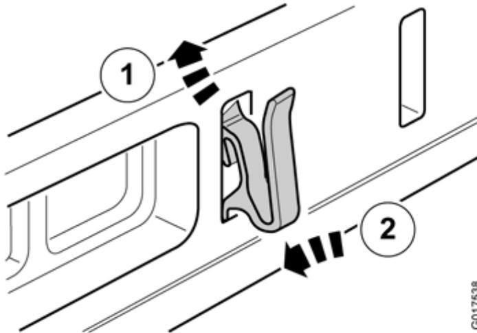
Die Haken einsetzen, indem sie zuerst an der Oberkante (1) und anschließend nach unten (2) eingeführt werden, bis sie in der Schiene einrasten.
