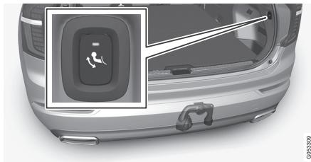
1. Abra el portón trasero. El botón para plegar y desplegar el enganche para remolque está situado en el lado derecho de la parte trasera del compartimento de carga. La luz de indicación del botón debe encenderse con luz fija de color naranja para que esté activa la función de despliegue.
