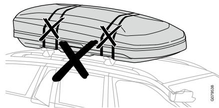
Gebruik nooit banden om het deksel te sluiten of de dakbox op de auto vast te zetten.
