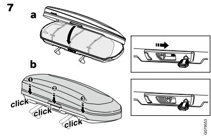
a, Deckel der Dachbox schließen
