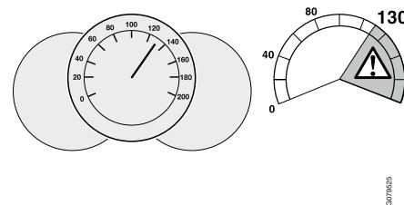
Die zulässige Höchstgeschwindigkeit niemals überschreiten, wenn die Dachbox montiert ist. Die Höchstgeschwindigkeit beträgt **130 km/h**.
