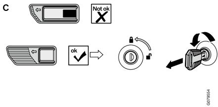
c, Controleer of de knop in de oorspronkelijke positie staat. Vergrendel het deksel van de dakbox door de sleutel linksom te draaien en verwijder de sleutel.
