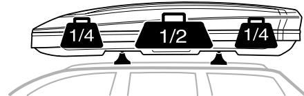
Verdeel de lading altijd gelijkmatig over de dakbox. De maximale capaciteit van de dakbox is **75 kg**.
