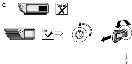
c, Assurez-vous que le bouton est dans sa position d'origine. Verrouillez le couvercle du coffre de toit en tournant la clé dans le sens inverse des aiguilles d'une montre et retirez la clé.
