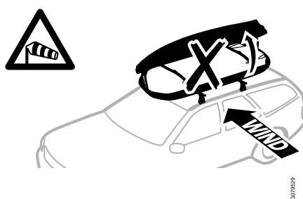
Stets sicherstellen, dass der Deckel korrekt geschlossen ist, da er sonst durch Seitenwind versehentlich geöffnet werden kann.
