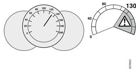
Overschrijd nooit de maximale snelheidslimiet als de dakbox is gemonteerd. De maximale snelheidslimiet is **130 km/h**.
