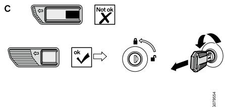
c, Sicherstellen, dass sich die Taste in der ursprünglichen Position befindet. Deckel der Dachbox verriegeln, indem der Schlüssel gegen den Uhrzeigersinn gedreht wird, dann den Schlüssel abziehen.
