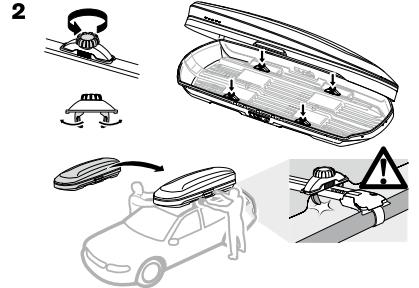
Desserrez les 4 attaches dans le sens inverse des aiguilles d'une montre
