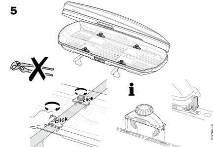
Sicherstellen, dass die Klemmen korrekt angebracht sind, siehe Abbildung
